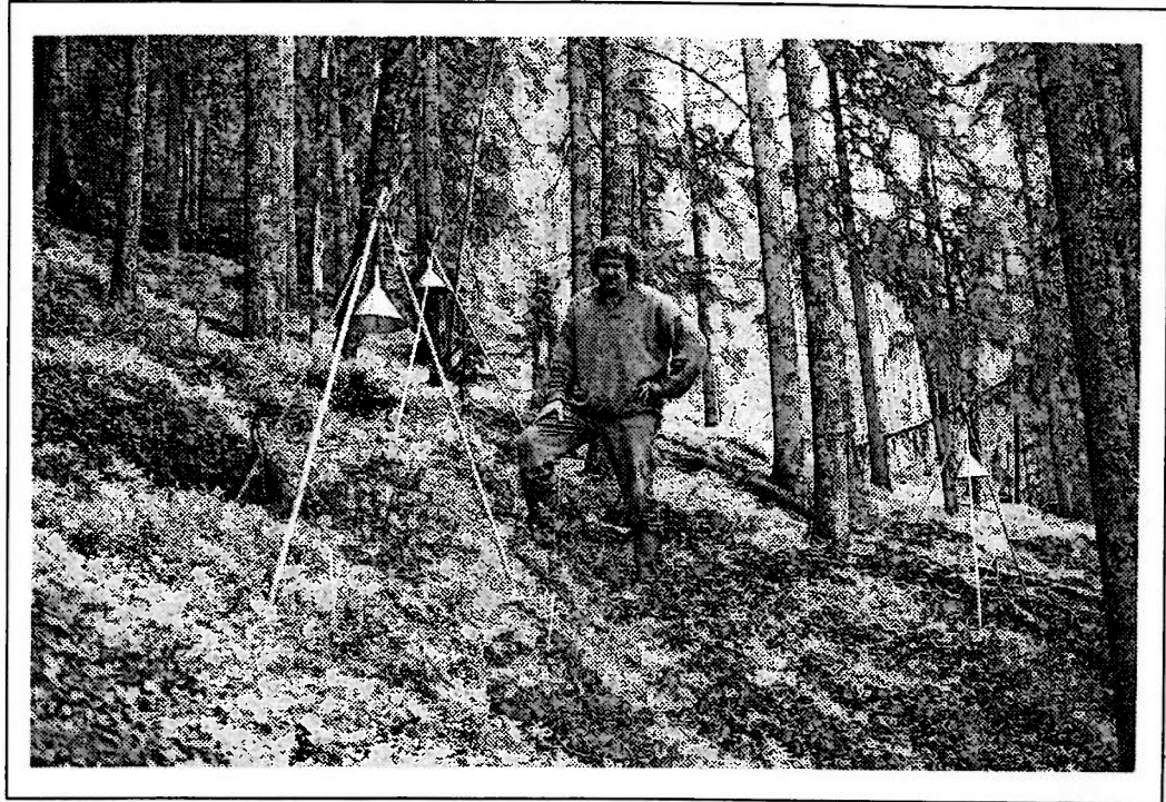
Figur 4. Målinger av luftkvalitet (aromatiske hydrokarboner) i felt 5. Tenax-adsorbsjons rør opphengt under metalltrakter. - Measurements of air quality (aromatic hydrocarbons) at site 5. Tenax adsorption tubes mounted beneath metal funnels.
